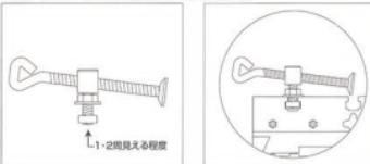
クランプ②に付属の六角ナットを上部、四角ナットを下部に移動させます。四角ナットの位置はクランプ本体のネジが1・2周程度見える位置にします。
