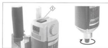
フライスマーターの電源スイッチ⑩を操作しモーターの回転を確認してください。
