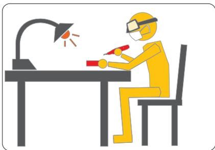
座った状態で、肘や手首をなるべく作業テーブルに固定させて作業すると安定した加工ができます。目や顔に近づけ過ぎないように注意してください。刃物の前方に指などが位置しないように注意して作業を行ってください。
