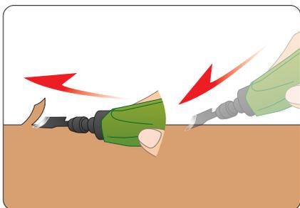
先端刃物を斜め（15度～30度程度）に木材に当て、振動を利用して彫り始めます。ある程度（1～3mm）の深さを保ちながら前方に押し進めます。目的の地点に達したら、本体をすくい上げるようにして、木材から離します。
