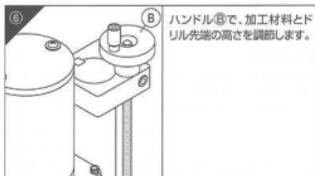
B ハンドル④で、加工材料とドリル先端の高さを調節します。
