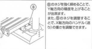
Ⓑのネジを強く締めることで、Y軸方向の精度を上げることができます。
