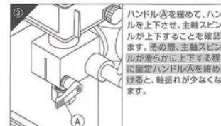
A ハンドル④を緩めて、ハンドルを上下させ、主軸スピンドルが上下することを確認します。その際、主軸スピンドルが滑らかに上下する程度に固定ハンドル④を締めつけると、棘振れが少くなります。
