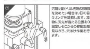
G 穴開け量(ドリル先端の移動量)を決めたい場合は、Gの目盛りを調整します。加工物に刃先が当たる位置を0に設定しそこからの移動距離を見ながら、穴あけ作業を行います。
