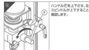
F ハンドル④を上下させ、主軸スピンドルが上下することを確認します。
