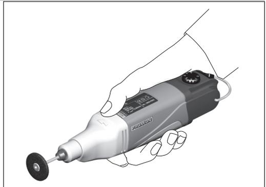
先端工具取り付け後、取り付けに使った工具類(スパナ等)が取り外されていることを確認し、試運転を行い、先端工具が確実に取り付けられていることを確認してから作業を開始してください。また、図のように、機体をしっかり保持し、作業を行ってください。
