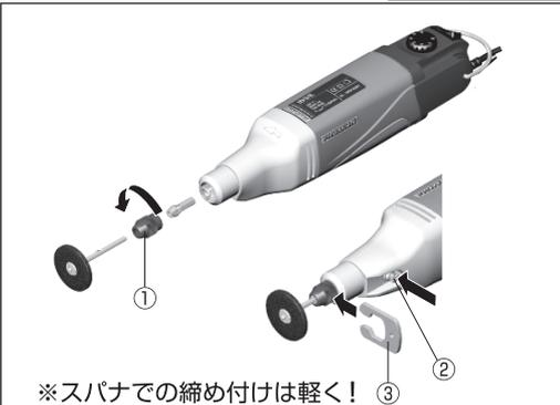
②のストッパーを軽く押さえながら、①のチャック部を指で回し、回転軸が固定される位置を捜し、固定します。そのまま、②のストッパーを押さえ、付属のスパナ③でチャック部①のカバーををゆるめます。コレットチャック交換時は図のようにカバーを取り外し、コレットチャックを交換してください。
