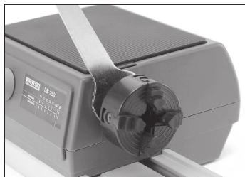
主軸に直接四爪インディペンデントチャック(以後四爪チャック)を取り付けます。主軸回転方向と逆回りに最後まで回してしっかりと取り付けます。
