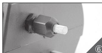
材料がコレットに入りにくい場合は、コレットの内寸と材料の外寸が合っていることを確認し、材料の端面角を少しヤスリなどで落としてください。各コレット寸法より材料の径が0.2mm以上大きい場合は、無理に材料を差しこまないでください。コレットの破損の原因につながります。
