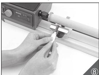
材料に適した回転数で、両手で刃物をしっかりと保持し作業します。その際必ず付属の防塵メガネを着用してください。
