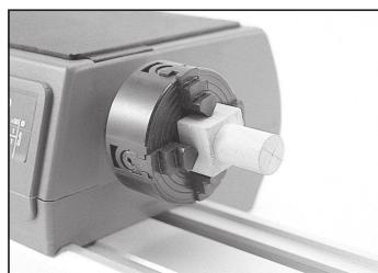
上図のように、短い材料であれば、心押し台で材料を押さえず、直接加工することも可能です。
