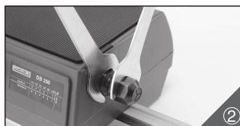
コレットカバーを付属のスパナ2本でしっかりと締めつけて材料を固定します。作業前に材料がしっかりと固定されているかを必ず確認してください。
