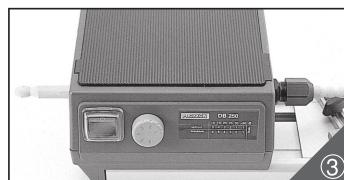
長尺材料は、上図のように、主軸貫通穴を貫通させることができます。本体モーターケースより、著しくはみ出るような材料を削る際は、材料を適した長さに切ってから作業を行ってください。本体左横に材料を支える台を置くと、材料にかかる負荷が軽減されます。
