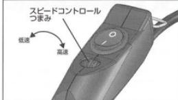
スピードコントロールつまみを回すと、主軸回転速度を調節できます。
