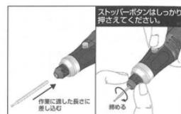
ストップーボタンを軽く押さえながら、チャック部を指で回し、回転軸が固定される位置を確認します。
